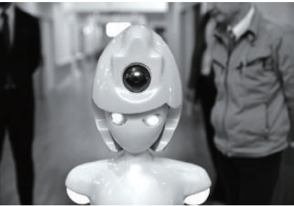
간호 로봇 '소완'은 집안에서 위급한 상황이 발생하면 언제든지 달려온다. 따라다니며 일일이 감시하는 것은 아니고, 평소에는 한 곳에 얌전히 서 있다가 고령자에게 무슨 일이 생길 때만 작동한다. 고령자는 손목에 맥박 등을 측정하는 장치만 착용하면 된다.
